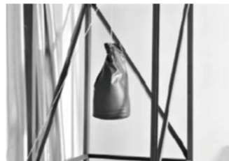
沙袋冲击测试 Sandbags impact
