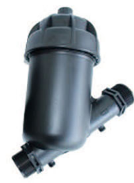
1-дюймовый фильтр для оросительной системы Максимальное рабочее давление: 6 кг/см² Расход: 333 л/мин (или 20000 л/ч)
