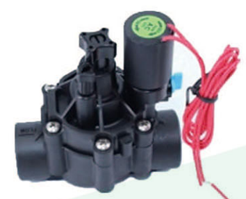
1-дюймовый электромагнитный клапан Рабочее давление: 0,10–1,04 МПа Расход: 0,45–34,05 м³/ч Температура воды: ≤43°C Температура окружающей среды: ≤80°C
