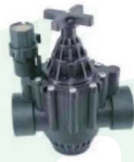
2-дюймовый электромагнитный клапан Рабочее давление: 0,10–1,04 МПа Расход: 0,45–34,05 м³/ч Температура воды: ≤50°C Температура окружающей среды: ≤80°C
