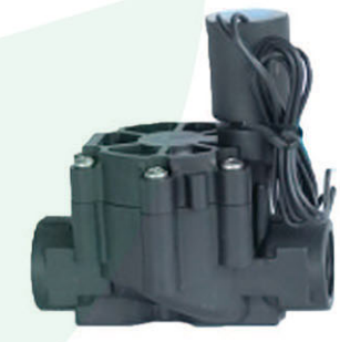
1-дюймовый электромагнитный клапан Рабочее давление: 0,103–1,034 МПа Расход: 0,05–9,08 м³/ч Температура воды: ≤50°C Температура окружающей среды: ≤82°C
