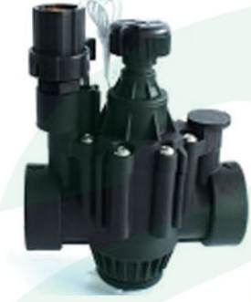
1,5-дюймовый электромагнитный клапан Рабочее давление: 0,10–1,04 МПа Расход: 0,45–34,05 м³/ч Температура воды: ≤50°C Температура окружающей среды: ≤80°C
