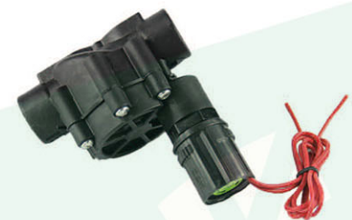
1-дюймовый электромагнитный клапан Рабочее давление: 0,103–1,034 МПа Расход: 0,05–5 м³/ч Температура воды: ≤43°C Температура окружающей среды: ≤82°C
