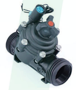
2-дюймовый электромагнитный клапан Рабочее давление: 0,5–10 bar Расход: 5–45 м³/ч Температура воды: ≤42°C Температура окружающей среды: ≤82°C
