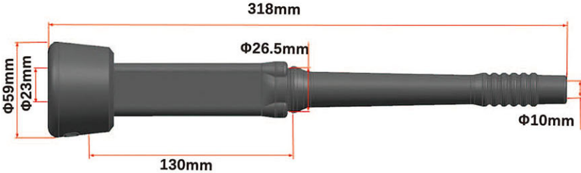
IP15S 无气孔 YH-ME105C 材质：橡胶
