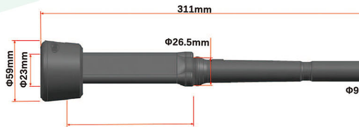
IP10S 无气口 YH-ME105A 材质：橡胶
