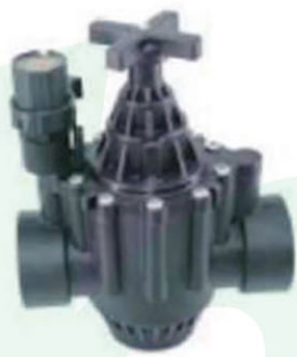
YH-CT119A 2吋喷淋电磁阀 工作压力:0.10~1.04 MPa 流量:0.45~34.05 m3/h 水温:≤50℃ 环境温度:≤80℃
