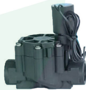
YH-CT118C 1吋喷淋电磁阀 工作压力:0.103~1.034 MPa 流量:0.05~9.08 m3/h 水温:≤50℃ 环境温度:≤82℃
