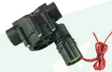
YH-CT118B 1吋喷淋电磁阀 工作压力:0.103~1.034 MPa 流量:0.05~5 m3/h 水温:≤43℃ 环境温度:≤82℃
