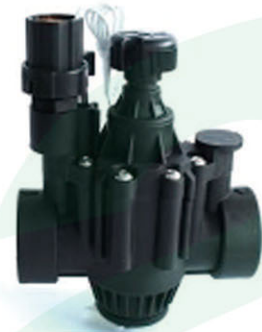
YH-CT119B 1.5吋喷淋电磁阀 工作压力:0.10~1.04 MPa 流量:0.45~34.05 m3/h 水温:≤50℃ 环境温度:≤80℃
