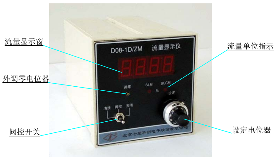
图 15. 流量显示仪操作面板
