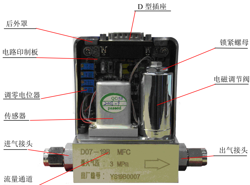
图 2. 质量流量控制器结构图
