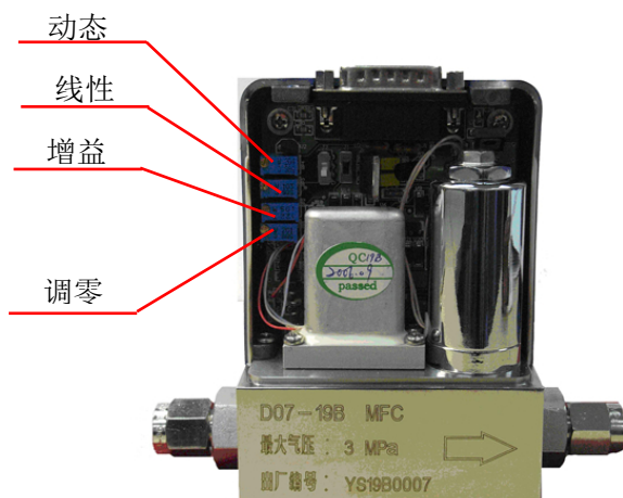
图 14. D07-19B、D07-19BM 型调零电位器位置图
