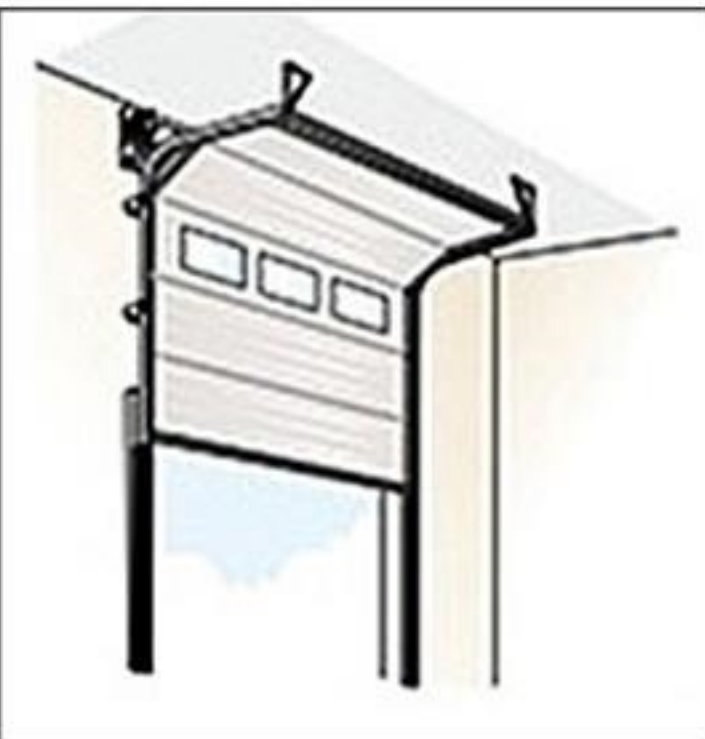
高位提升 适用于门顶空间 >500MM<门洞高度
