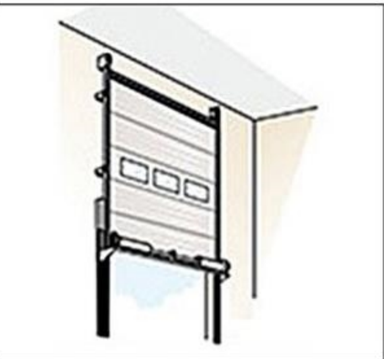
垂直提升 适用于门顶空间 ≥门洞口高度
