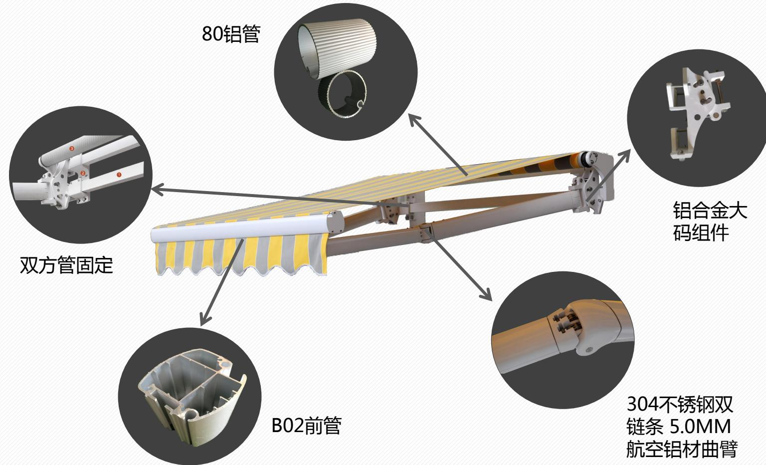
B02管壁采用5.0MM航空铝材特制而成、坚固、不易变形、抗风能力强,和结构厚实的臂头挂码相配合,轻松吊重350KG以上,白色烤漆使得防腐蚀性增强。
