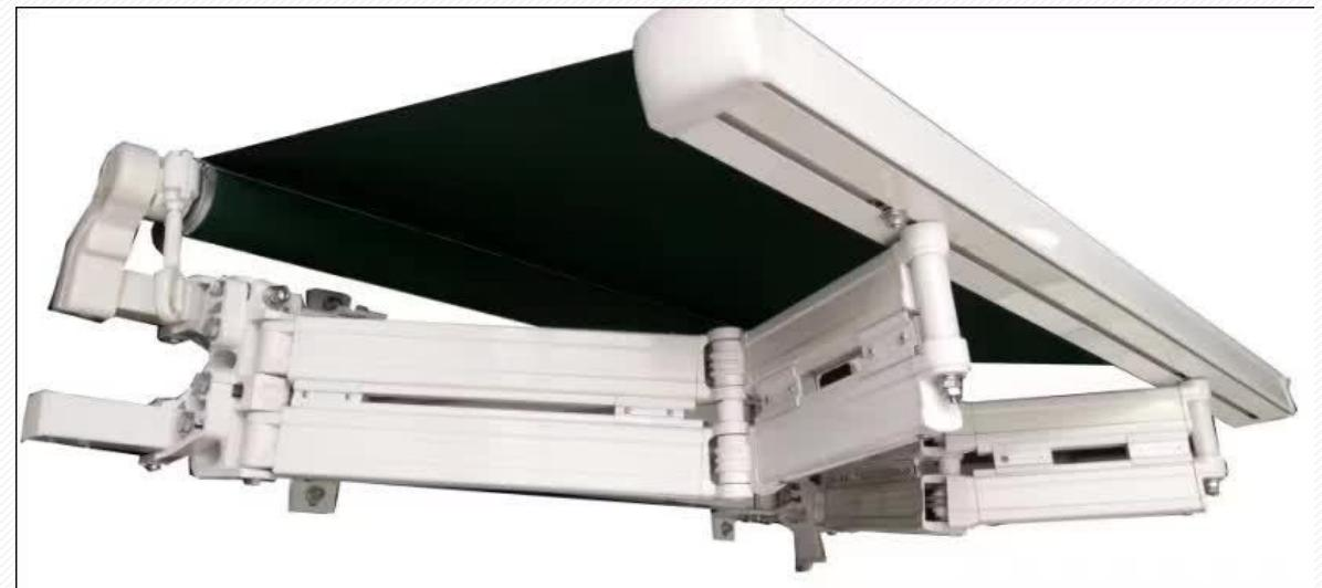
竞品，通过双臂受力，但是这种造型设计用臂管连接，连接件如果遭到损坏，容易让整个篷缺少承重点，出现塌陷情况，安全系数相比较低
