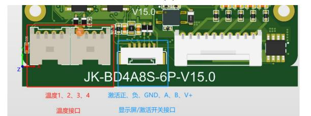
V11 B-CAN/ RS485 GND RX TX VCC K- K+ GND B A VCC CD- CD+ (3~7为H+) RS485/CAN通信接口 GPS接口
