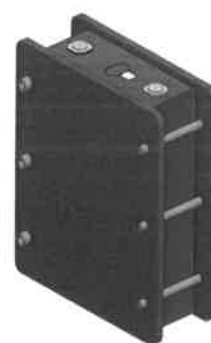
Fig. 4 Diagram of cell with clamp 图 4 电池上夹具图
