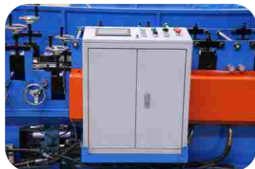
PLC 제어 캐비닛 PLC Control Cabinet
