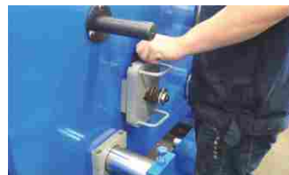
1. 고정핀 풀림 Loosen locating pin
