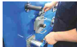
3. 고정핀 고정 Fix locating pin
