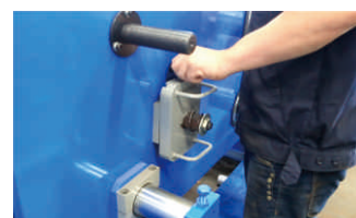
1. 拔出定位销 Loosen locating pin
