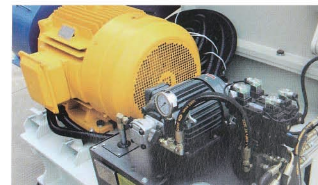
专配高效节能电机和强大动力源。 Equips energy efficient motor and powerful hydraulic drive
