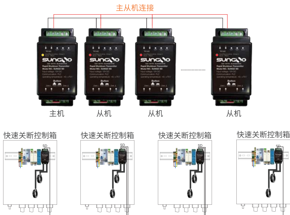
多个快速关断控制箱主从机连接示意图
