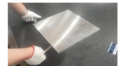
Super flat plate with <0.1mm / m 2 flatness 超平板平整度可达10丝每平方米以内
