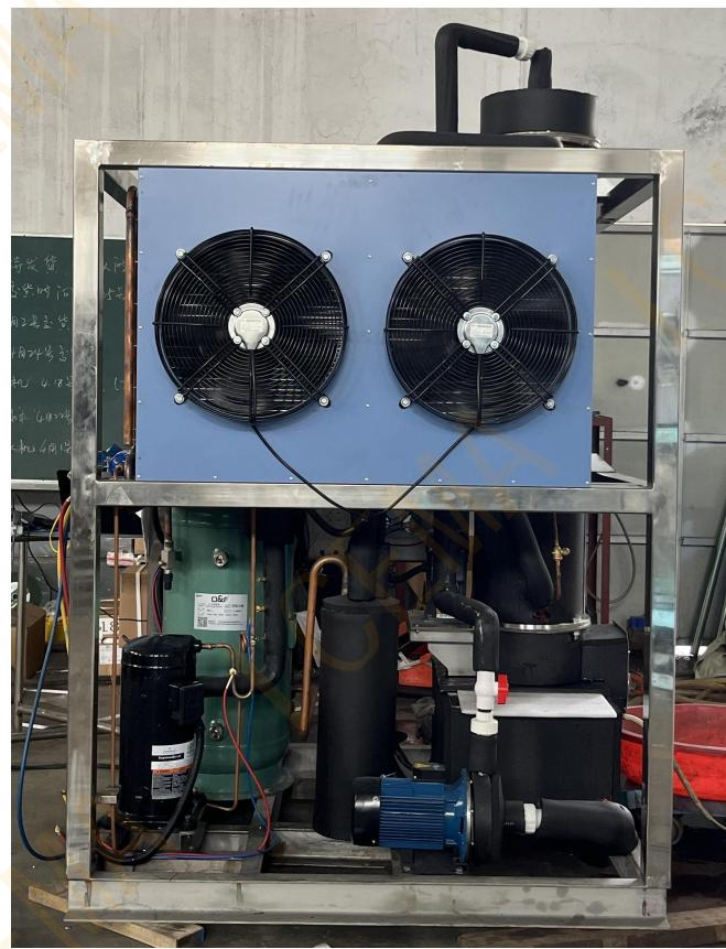
第三步：打开已关闭的阀门。打开方式：拆开阀件处黑色外壳，将阀芯向外拧。
