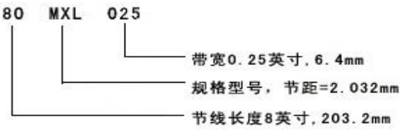
MXL 梯形同步带规格、型号、尺寸(节距=2.032mm)
