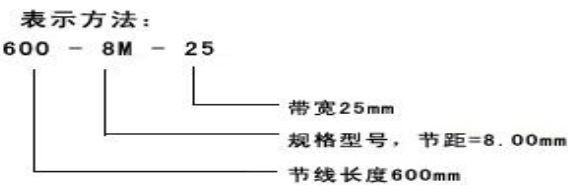
8M 圆弧齿同步带规格、型号、尺寸(节距=8.00mm)
