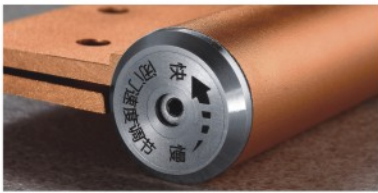
闭门速度调节 顺时针旋入 8mm 刻度位 为最佳关门速度 (推荐)
