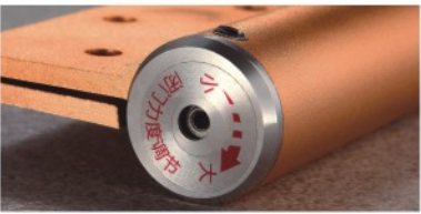
闭门力度调节 顺时针旋入 12mm 刻度位 为最佳关门力度 (推荐)
