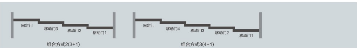
同步同向木门联动 可以组合更多的组合方式
