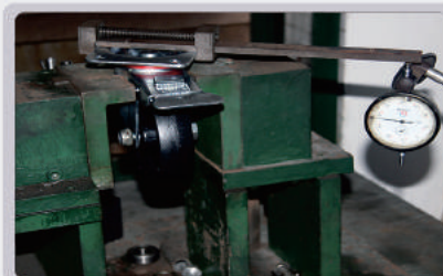
底板晃动测试 BASE SHAKING TEST
