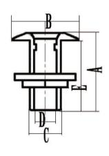
全丝出水口 Through Hull Outlet
