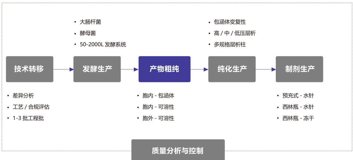
粗纯的作用是分离差异较大的物质,如固液分离、胞内或胞外物质分离。以大肠杆菌或酵母为表达平台的粗纯工艺,包括培养上清、胞内可溶物或包涵体的分离,通常选择离心和破碎的方式实现。由于小试与生产规模不同,适配的离心和均质设备也有所差异,而离心和均质参数的转换尤其重要,很大程度上影响产品的质量和收率。
