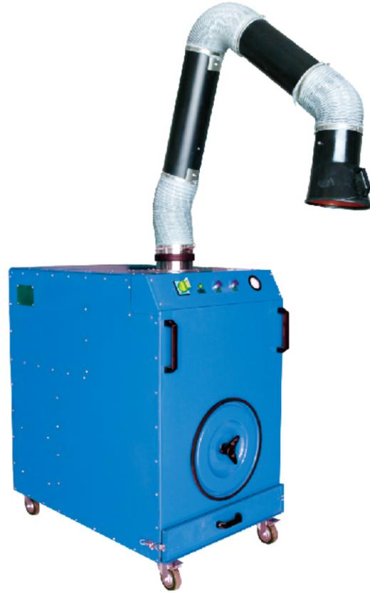
吸气罩吸收的焊接烟尘通过吸气臂进入过滤单元内部,首先撞击分流板,改变气流方向,使气流向上流动,这样可避免直接冲击滤芯,也得到了循环,大颗粒的粉尘被过滤筒收集前先分离出来,细小颗粒经过有PTFE薄膜的过滤筒过滤分离,过滤后干净的空气通过消声排入外界,完成过滤的全过程。带有PTFE薄膜的过滤筒分离的烟尘颗粒,在脉冲反吹作用下,粉尘落入粉尘容器,进行收集。
