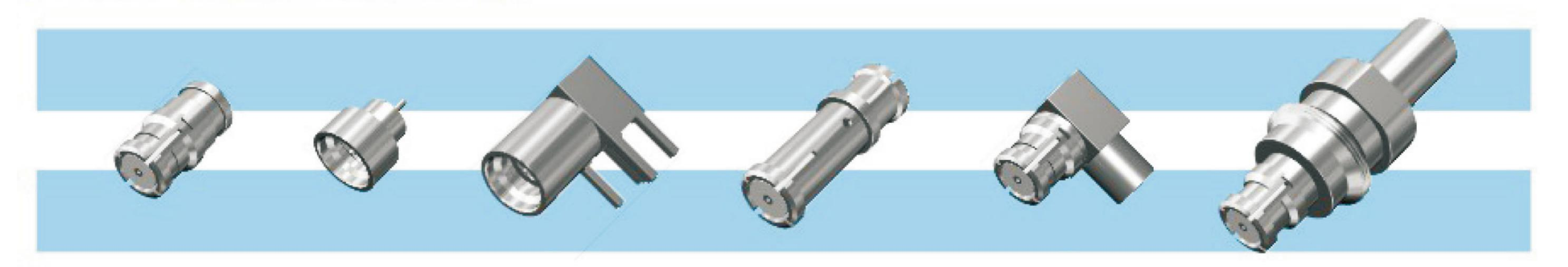
SMP系列插入自锁式同轴连接器,主要用于射频模块间的密排连接,具有易于连接、重量轻、抗震性强、使用频率高等优点。其特点是:1:密排时连接中心距可达4.32mm;2:径向0.51mm和轴向0.25mm的偏差自适应更适合盲插连接;3:电缆接头所带的防震环保证了连接器的机械稳定性;4:插头转换器的一端比另一端具有更高的插拔力,使得模块分离时转换器可以留在插拔力高的一端。
