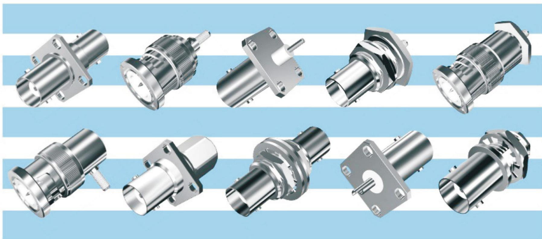
BMC系列产品是按照MIL-C-39012, IEC169-8 详细规范研制生产的一种卡扣式射频同轴连接器，具有连接迅速、接触可靠等特点，广泛用在无线电设备和仪器中连接射频同轴电缆用。特别适用于在振动条件下的移动通信设备中。
