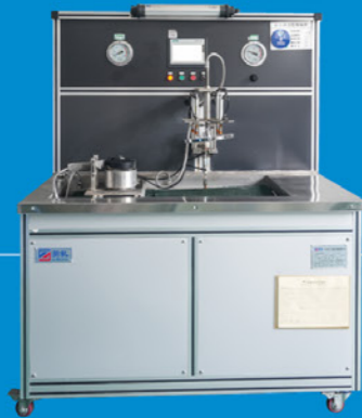
花洒功能转换寿命试验 Shower Head Function Switching Endurance Test
