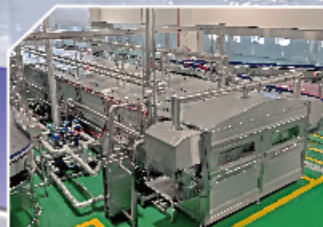
喷淋冷却系统 Showering & Cooling Tunnel 产能 Capacity: 5000-43200BPH
